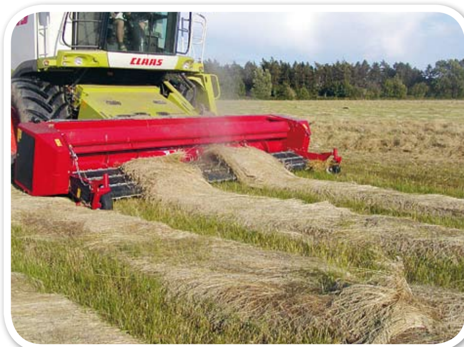
Löpande band. Band-pickupens uppsamlings- och transportutrustning består av ett gummiband med påmonterade stålträdsfingrar samt inmatningsskruv.
