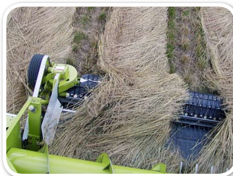
Upprivande. Pickup-bord modell Rake-Up som består av kamrotor, gummiband och inmatningsskruv. Rake-Up anses vara bättre till mycket tunna strängar än band-pickup.
