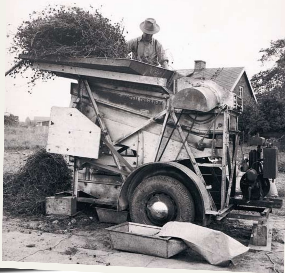
Tröskning av klöverfrö på en stationär parcelltröska.
