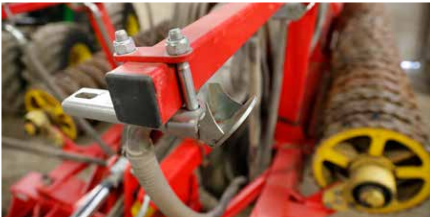
Väderstad vältsådd. Väderstads BioDrill går numera att applicera på de flesta maskinerna. Här på en vält som man använt för rödklöver sådd – med bra resultat.
