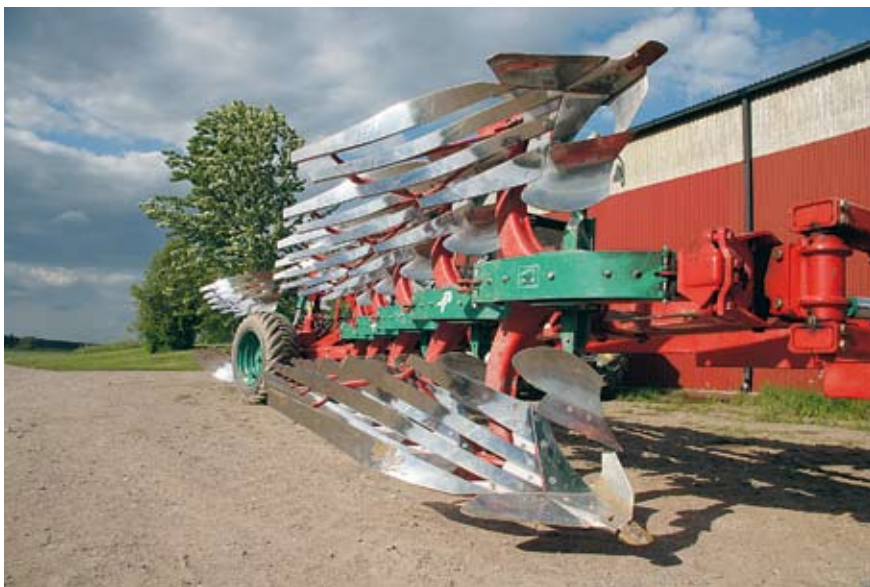
Slukar halmen. En ny 8-skärig Kverneland vagnplog med spaltvåndskivivor är navet i bearbetningen för att få ner höstrågens halm. Den ersätter en Ecomat som inte klarade av att hantera de stora halm mängderna efter rågen.
